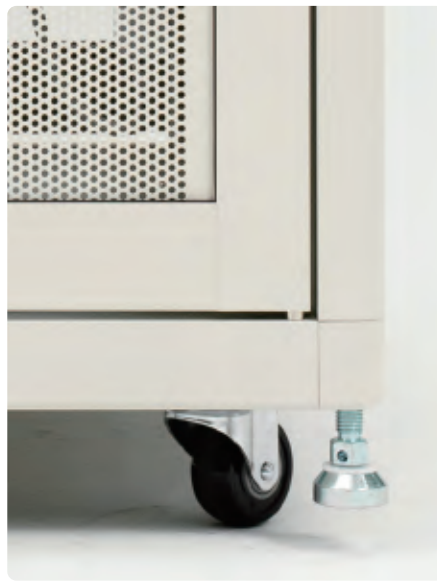
2.5"活動輪便於運送 / M16地平螺絲可克服傳統機房無高架地板的水平問題
